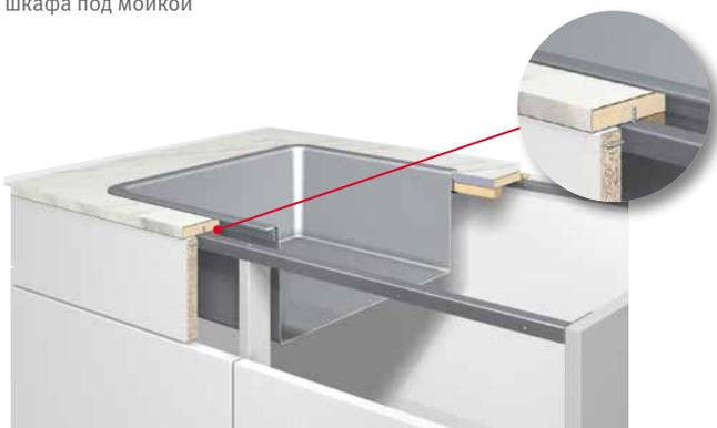
Столешница с поверхностью PerfectSense Topmatt с металлической планкой для напольного шкафа под мойкой
