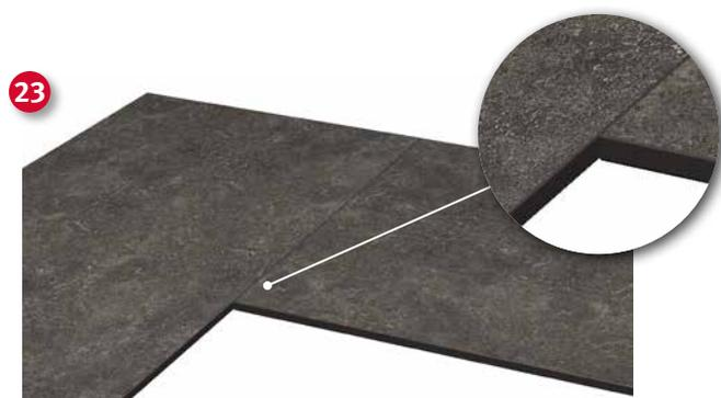
Обработка герметиком начинается с прокалывания защитной мембраны тюбика и последующего навинчивания черного дозатора для нанесения герметика – см. рис. 22. Затем этим дозатором проводят вдоль стыка по лицевой стороне столешниц и равномерно выдавливают герметик из тюбика. Сразу после нанесения герметика столешницы следует плотно соединить и скрепить винтами. Излишки герметика, которые, возможно,
